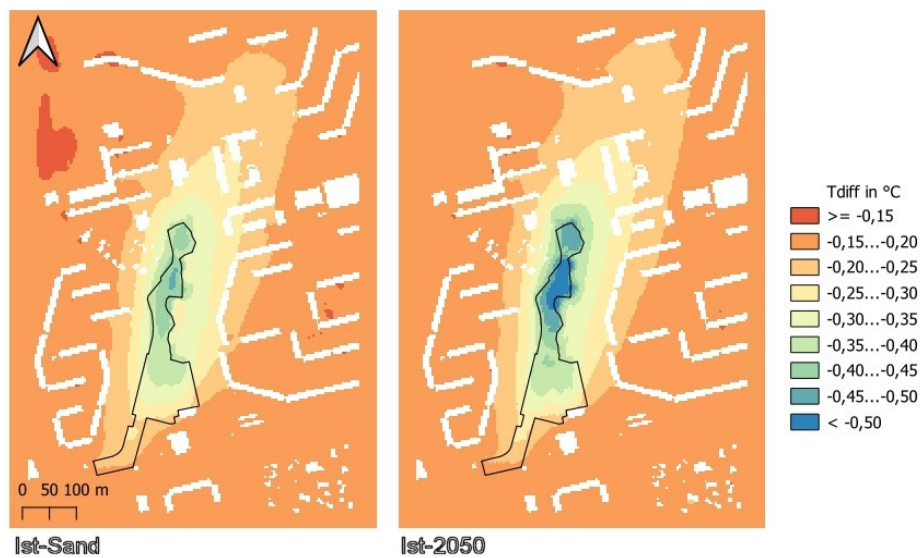
Abbildung 4: Differenz der Tagesmitteltemperatur zwischen dem Ist-Zustand bzw. dem Endzustand 2050 des urbanen Waldes im Schönauer Holz zum Zustand nach Abriss der Plattenbauten (Modellzustand „Sand“).
